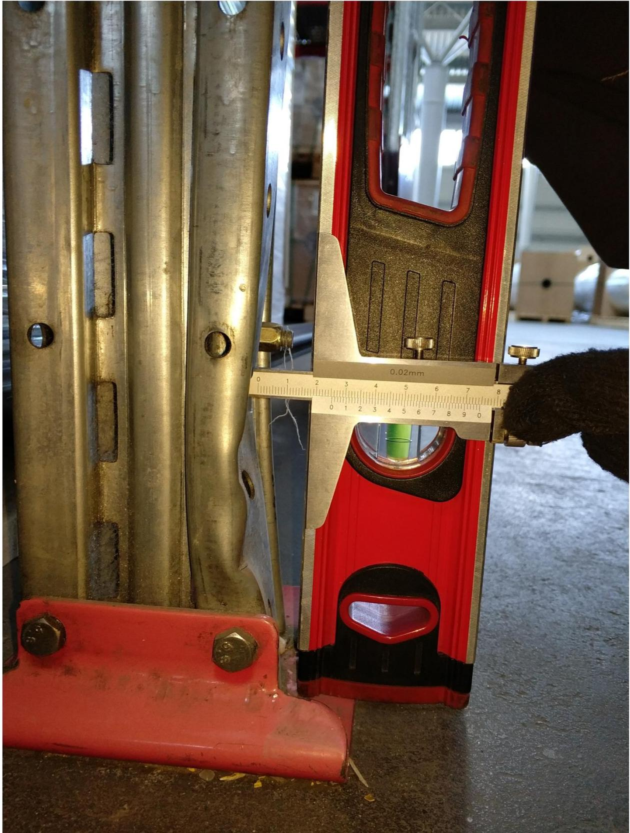
После замера в журнале частичного технического освидетельствования делается пометка, например: №1 – деформация стойки 18мм, Ряд С, Рама №7 (Номер ряда / порядковый номер рамы в ряду (слева на право)).
