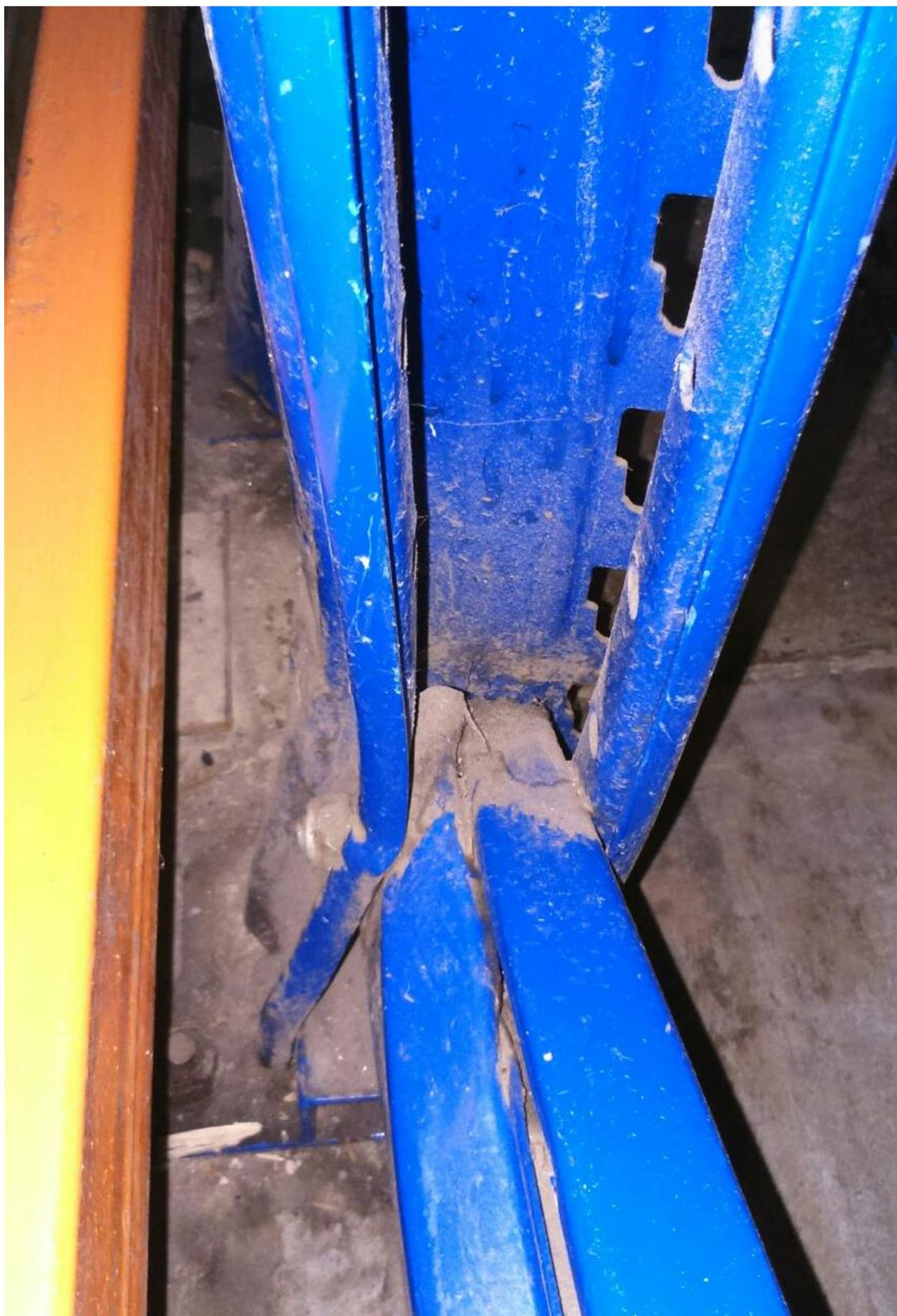
Разрыв металла вертикальной стойки
