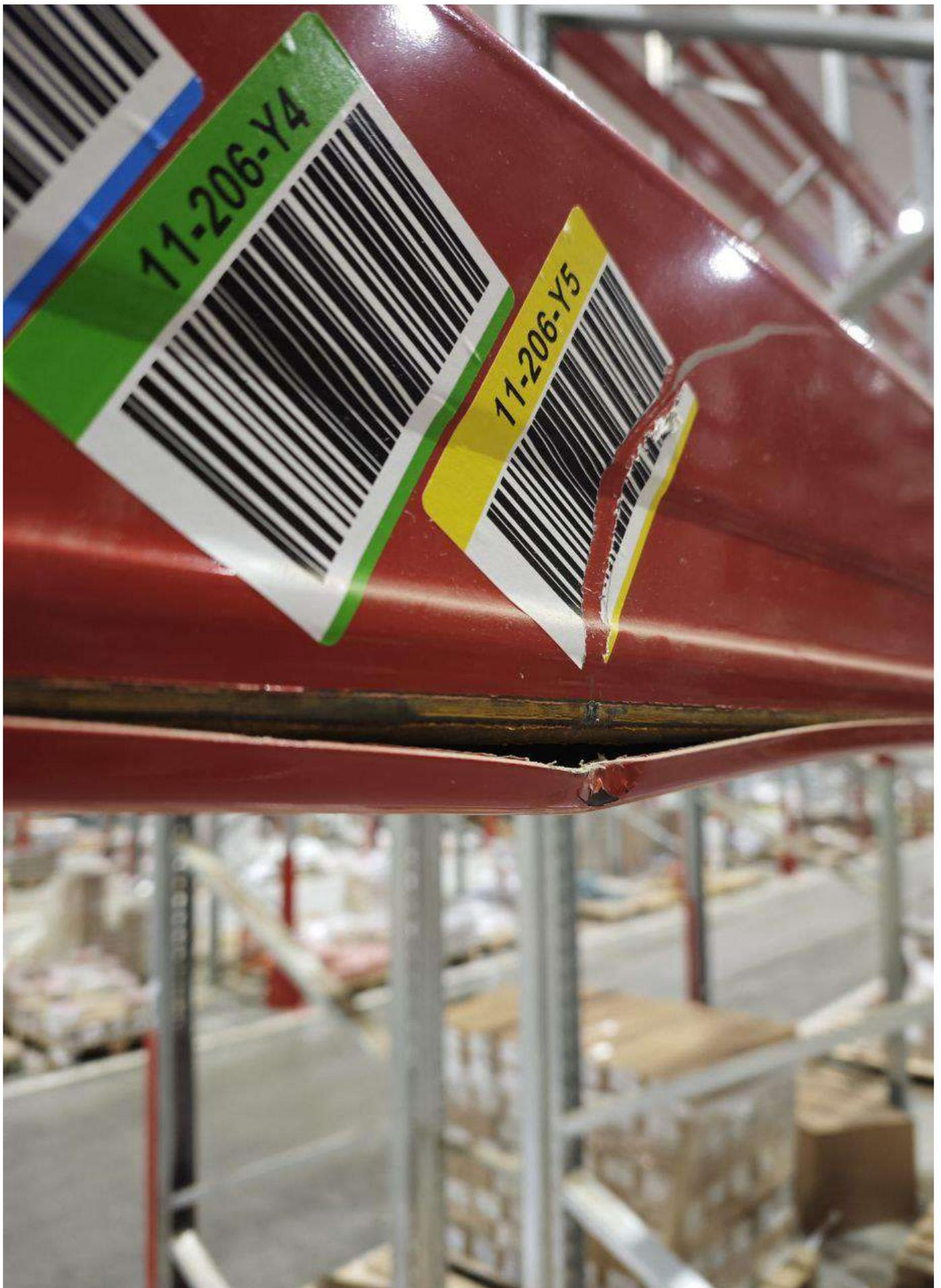
**Усталость металла - трещина – циклы загрузки и разгрузки (14 лет работы).**
