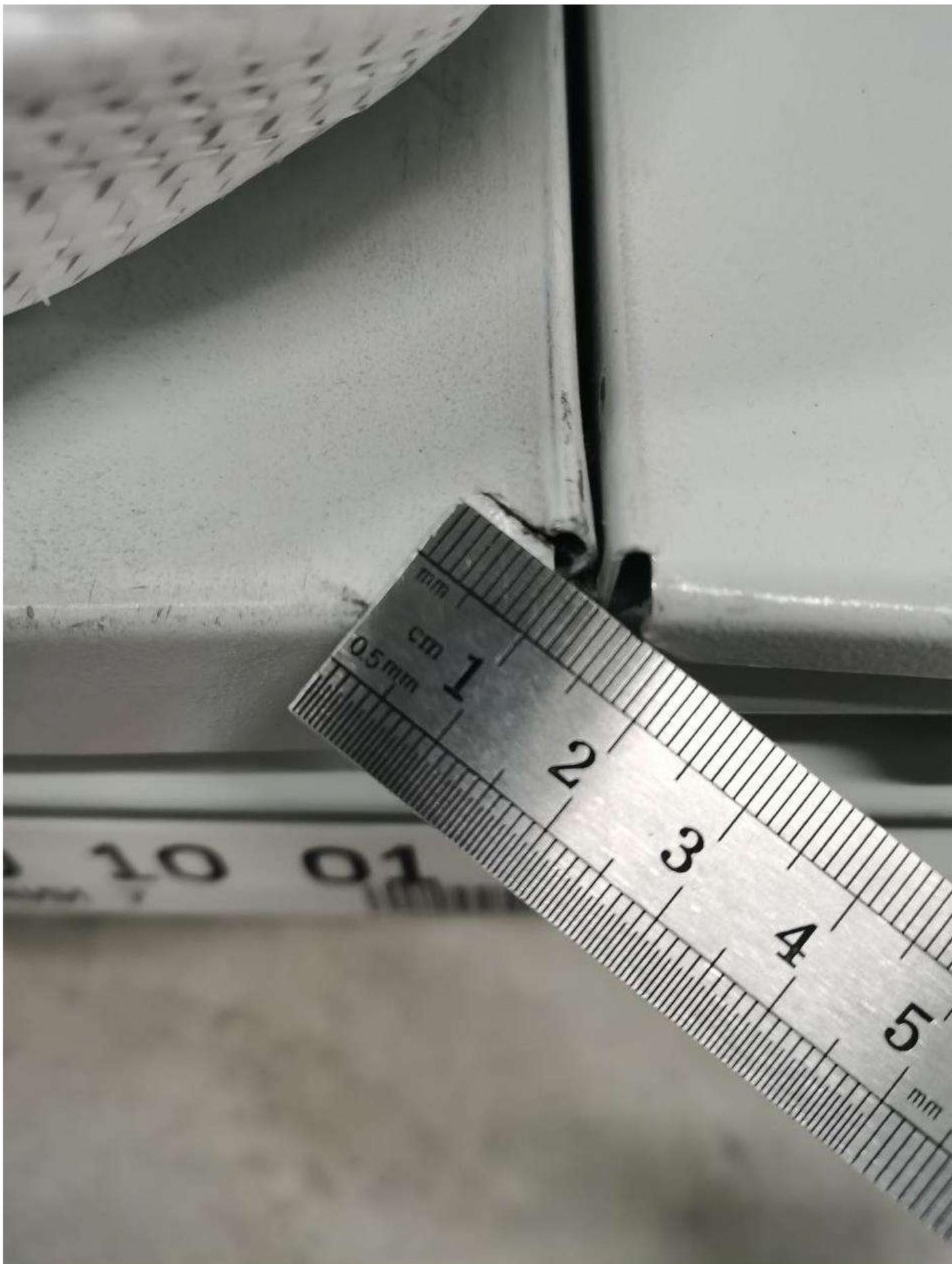
**Полное рассоединение балки и стойки, правый край балки «висит» в воздухе**
