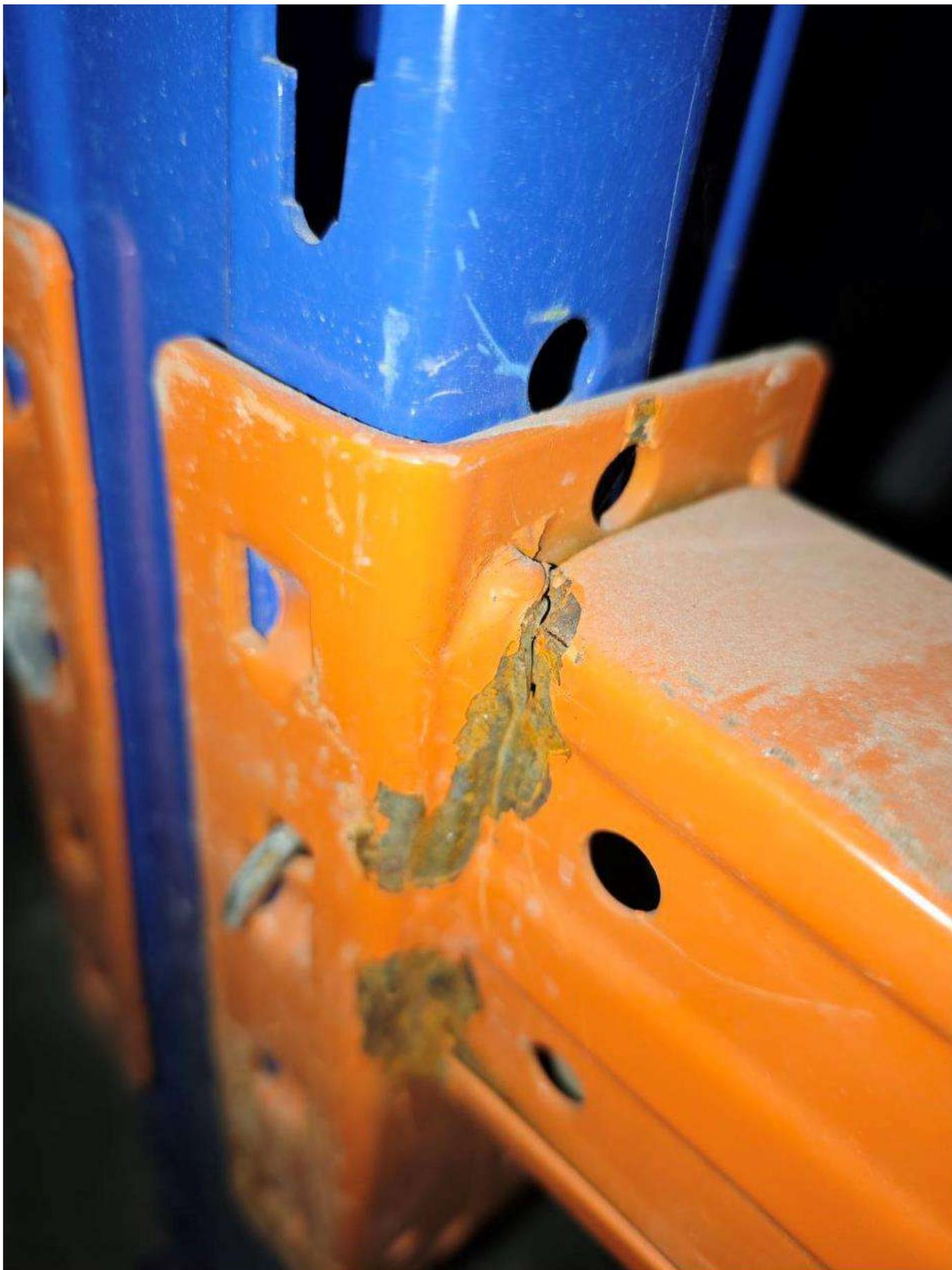
**Усталость металла – едва заметная, но уже выраженная гармошка – опасно!!!**
