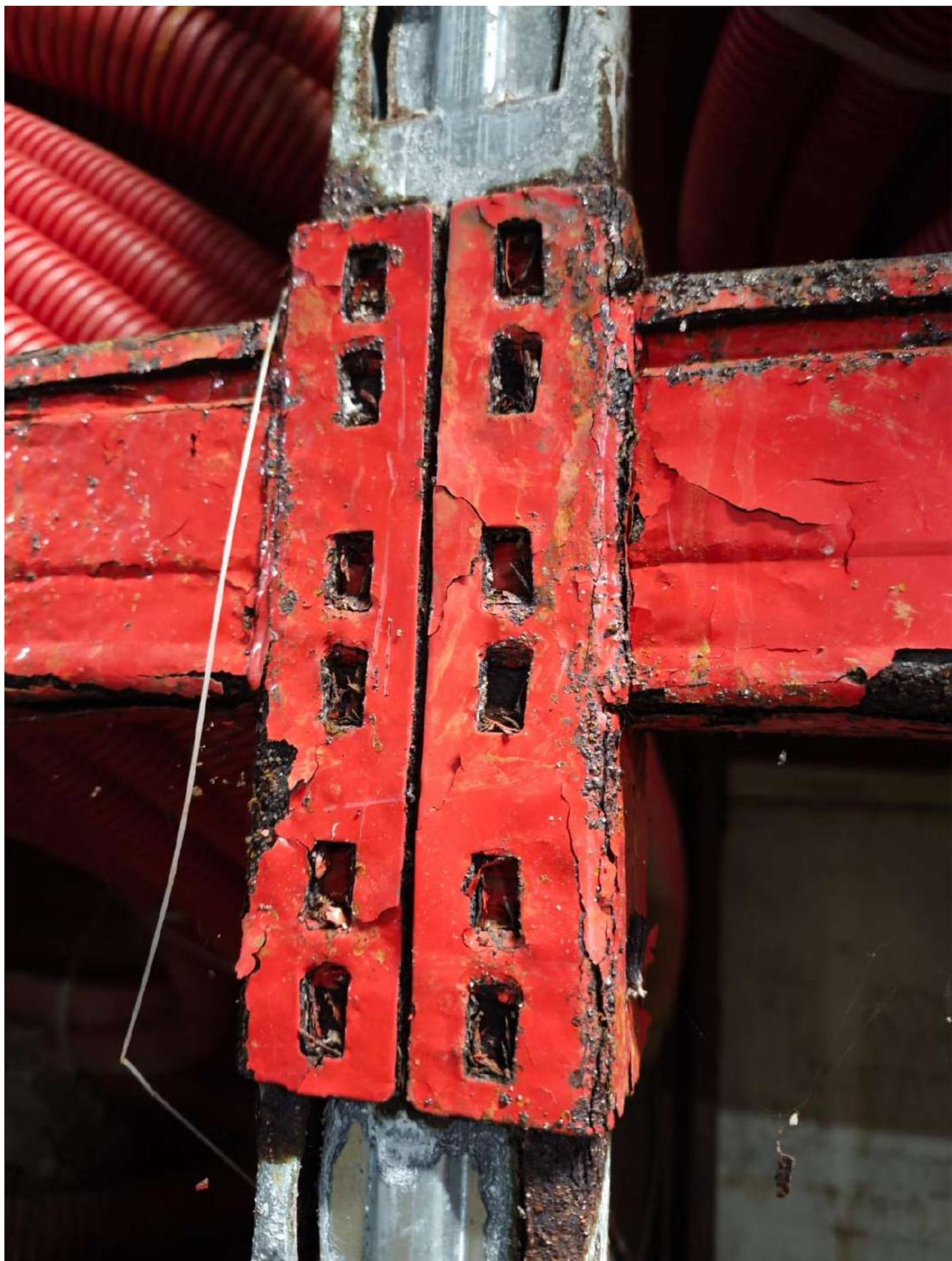
**«Вывешивание» стойки вследствие нарушения геометрии стеллажа (наклон)**
