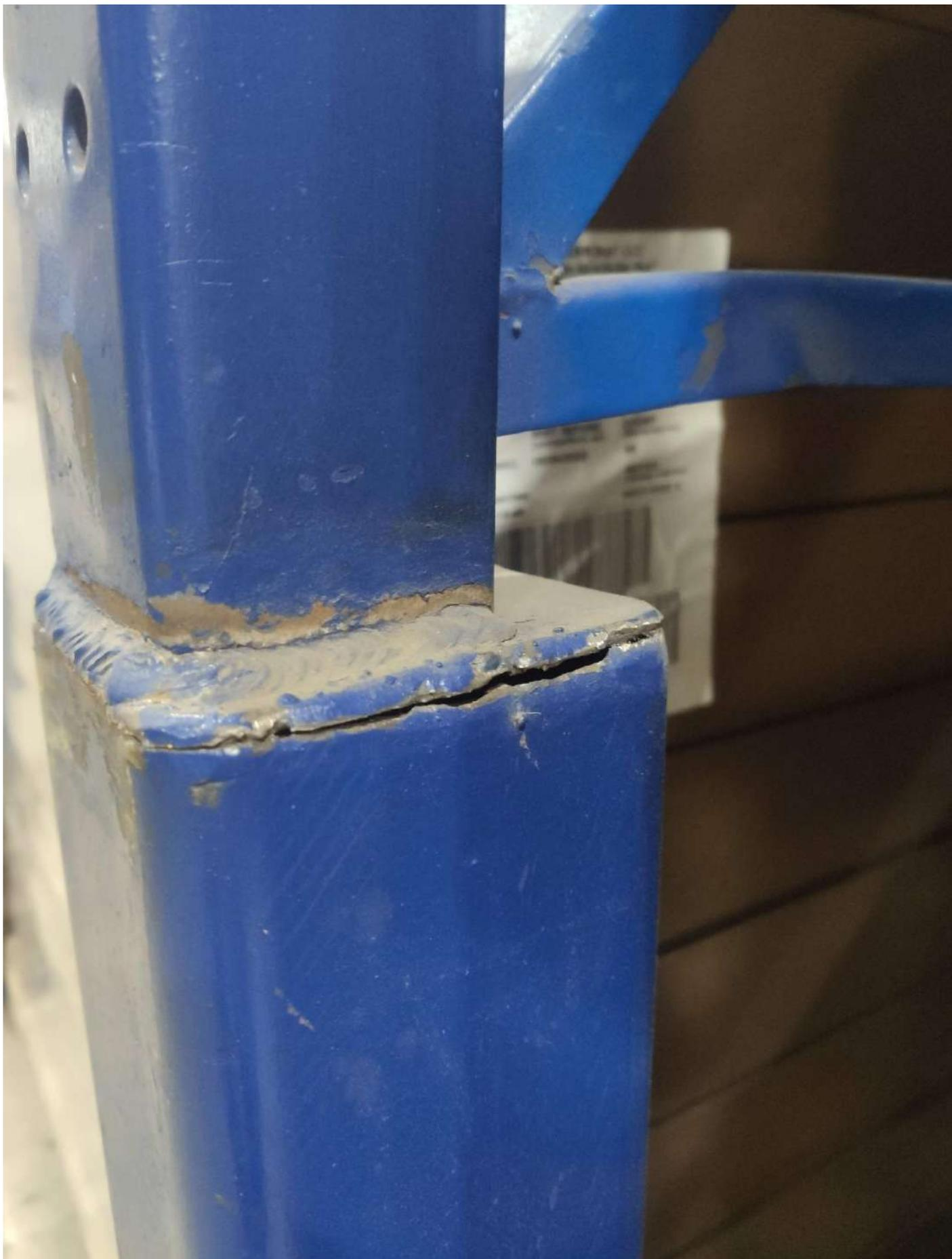
**Скрытая деформация, которую видно только изнутри стеллажа**
