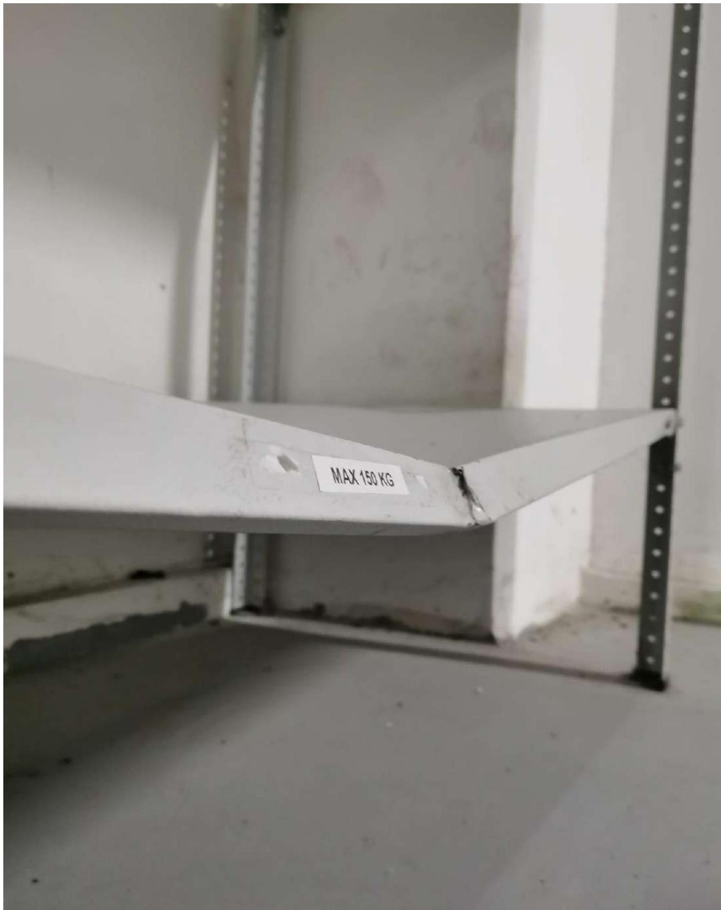
**Деформация ложеента (направляющей) набивного стеллажа от удара паллетами**
